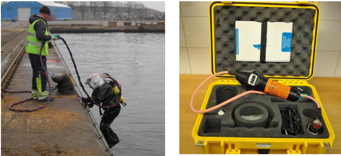
Figur 4: Fältarbete i Halmstad hamn. Bilden till höger visar den ultraljudsmätare som användes vid mätning av kvarvarande godstjocklek i stålsporten.
