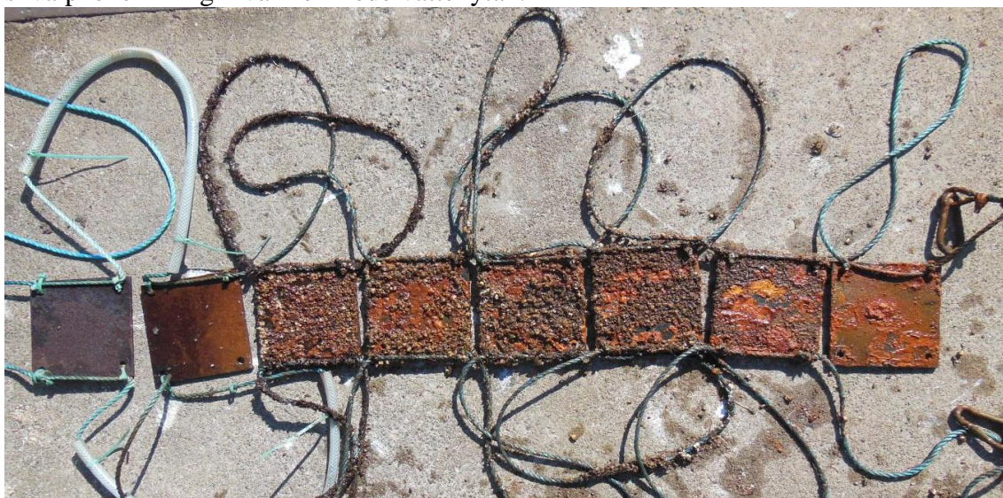
Figur 5: Stålplåtar efter ett års exponering i Halmstad hamn. Plåten längst till vänster har exponerats ca 1 m över medelvattenytan, medan plåten längst till höger har varit belägen på ca 6 m djup.
